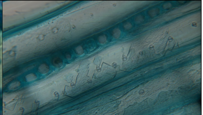
Abb. 35: Erosion-Bakterien (durchlichtmikroskopisch) im Nadelholz; Befallsgrenze: oben ohne - unten mit massiven Befall; ca. 500-fach.
