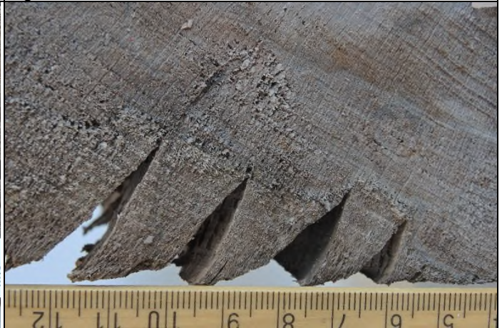
Abb. 29: Querschnitt: Bruchbild einer Bakterienfäule an Buche.
