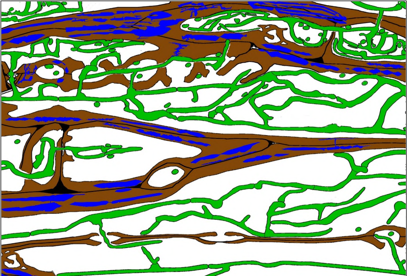
Abb. 18: Typischer Angriff eines Moderfäulepilzes im Holz (schematische Darstellung); die Kavernen (blau) werden direkt in der Holzzellwand gebildet; im Lumen wachsen zudem Hyphen von Schimmel- und Moderfäulepilze (grün).
