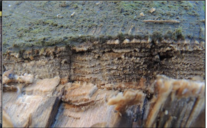
Abb. 48: Probennahme-Punkt: Lupenaufnahme des bakterien- und moderfaulen Holzes mit zonierte Holzabbau besonders im dunkler verfärbten Spätholz.
