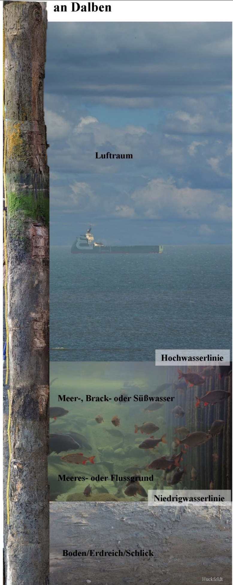
Abb. 38: Eine Dalbe ist in den unterschiedlichen Höhen verschiedenen biotischen Belastungen ausgesetzt, die sehr unterschiedliche Lebensräume bedingen; Haupt-Schaden und -Aspekte jeweils genannt (Bildmontage: T. Huckfeldt).
