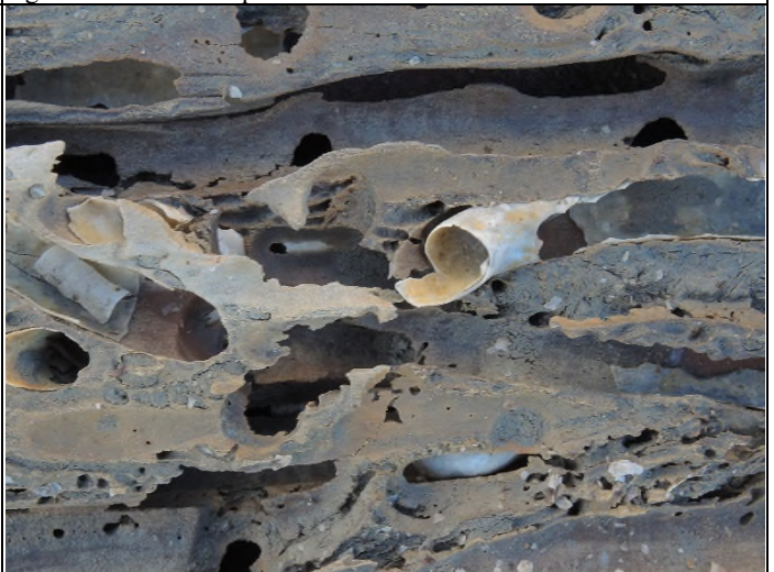
Abb. 44: Dalbe mit Bohrmuschel-Befall ( Teredo navalis ); Gänge der Muschel mit Kalk-Auskleidung.
