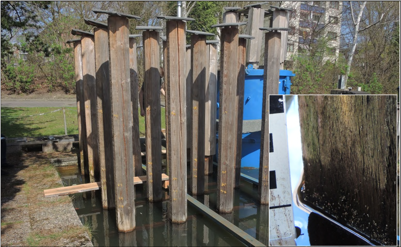
Abb. 57: Übersicht Klotzteil mit den Probe-Dalben/-Balken im Süßwasser (Thünen-Institut für Holzforschung, Hamburg).
