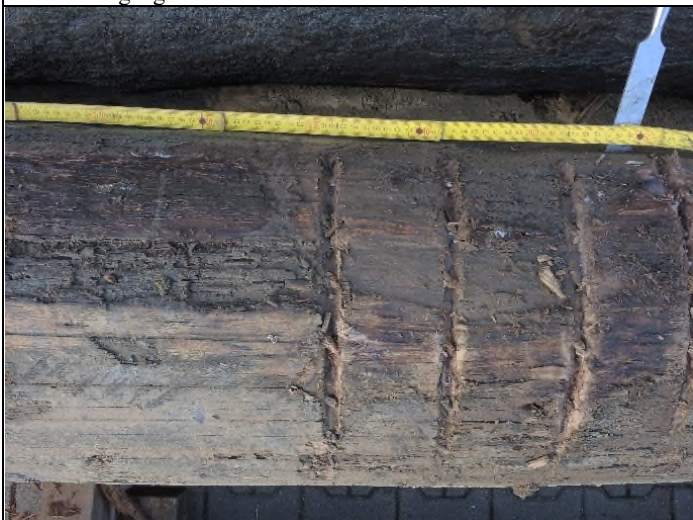
Abb. 45: Wasser-Luft-Zone (Tidenhubgrenze) vorwiegend mit Schäden durch Moderfäulepilze; für Muscheln und Asseln ist der Bereich zu „trocken“.
