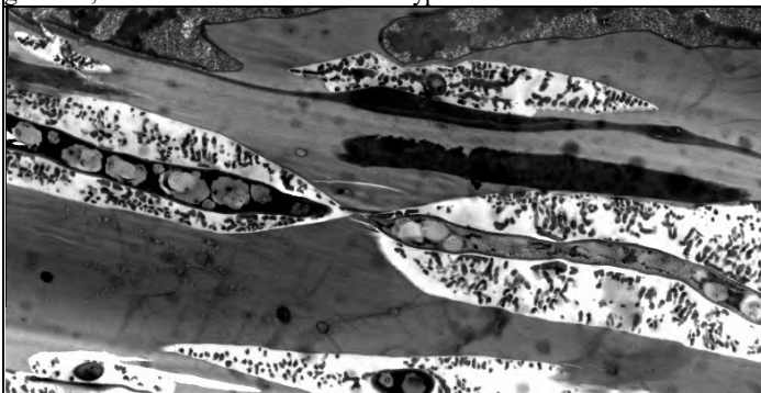
Abb. 19: Elektronenmikroskopische Aufnahme; Längsschnitt, Tropenholz: spitz zulaufende, fast perlenschnurartig angeordnete Kavernen; Hyphen in den Kavernen sichtbar – ca. 1500-fach.
