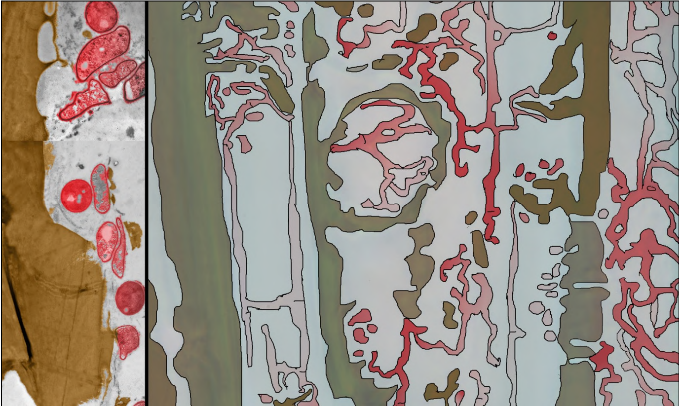
Abb. 16: Weißfäule-Abbaumuster; Angriff des Ausgebreiteten Hausporlings ( Donkioporia expansa ); Hyphen wachsen im Lumen des Holzes und bauen die Holzsubstanz (braun) vom Lumen herkommend ab; rötlich: Hyphen und Hyphenanschnitte; rechts: coloriertes elektronenmikroskopisches Bild; Vergrößerung ca. 2500-fach; links coloriertes lichtmikroskopisches Bild (mehrere Ebenen); Vergrößerung ca. 1000-fach.
