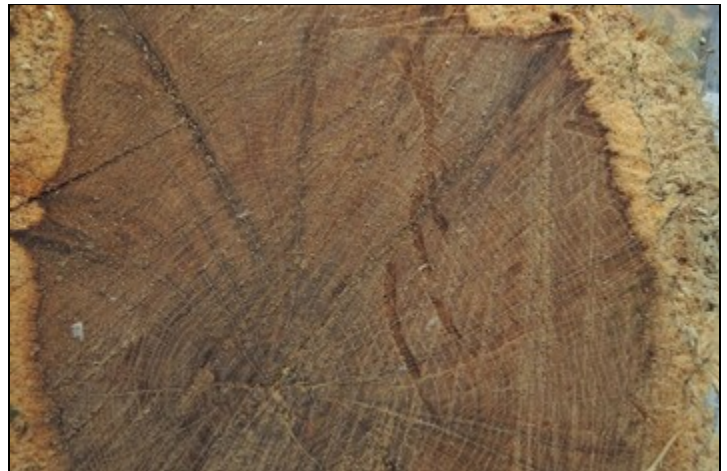
Abb. 5: Eichenholz - Splint- versus Kernholz: innen dauerhaftes Kernholz - ohne Fäuleschaden; außen nicht dauerhafte Splintholz – weißfaul und zerstört.
