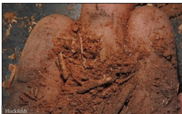
Abb. 2: Finger-Reibprobe an braunfaulem Holz: zerriebenes Holz im finalen Abbaustadium – die Holz-Struktur ist zerstört. Nach dem Zerreiben bleibt ein braunes, staubendes Pulver zurück – fast wie Humus-Erde. Die Finger werden schmutzig und wirken fast wie mit Kaopulver bestäubt. Im Holz wachsende Schimmelpilze führen oft auch zu einer Schwarzfärbung.
